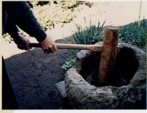
1 粘土調整 ウスで粘土をつく。
