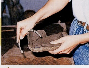
9 型入れ 粘土のあまりを取り除く。
