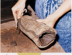
12 粘土除去 余分な粘土をけずり取る。
