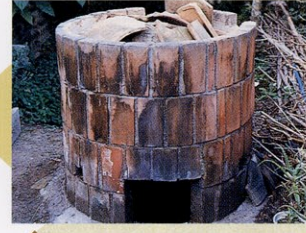
19 窯詰め完了 窯はレンガ作りの桶窯。
