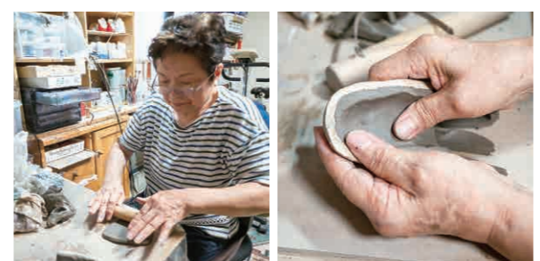
陶芸用粘土を練り柔らかくし、人形の前後と後ろに分かれている型に押し込む。型の奥まで粘土が行き渡ったかどうか指の感触で確かめながら念入りの作業が続く。昔は隣接する中之島のレンコン田の泥土が人形づくりに適したことから、春に田起こしをする時に土を貰いに行ったという。
