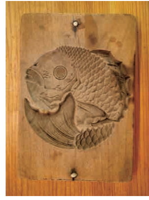
丸鯛を成形するための木型。実際の菓子と反対に絵柄が彫られている。江戸後期に洗練の極致に達した粉菓子の製造に欠かせない道具。
